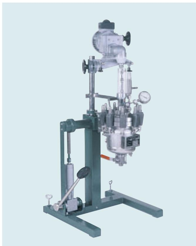
2-Liter-Druck-Reaktor mit Klammerschrauben, Antrieb und hydraulischer Deckel- und Motor-Positionier-Vorrichtung
